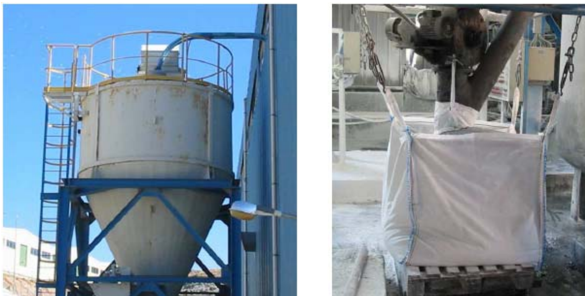
Εικόνα 32: Χοάνη συλλογή ιπτάμενης τέφρας και αποθήκευσή της (ΕΣΔΚΝΑ, 2007).
