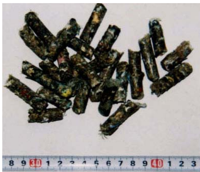
Εικόνα 11: RDF (Japanese Advanced Environment Equipment, 2008).
